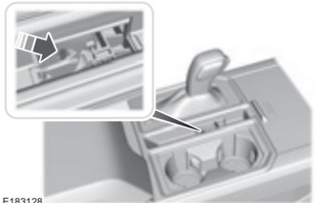
4. Presione el pedal de freno. Realice un poco de presión con el dedo, mueva la palanca blanca hacia adelante al mover la palanca de cambios para cambiar la marcha de estacionamiento (P) y colocarla en punto muerto (N).
